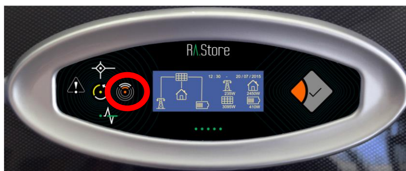
Figura 24 - Led di comunicazione si accende se la configurazione è andata a buon fine
